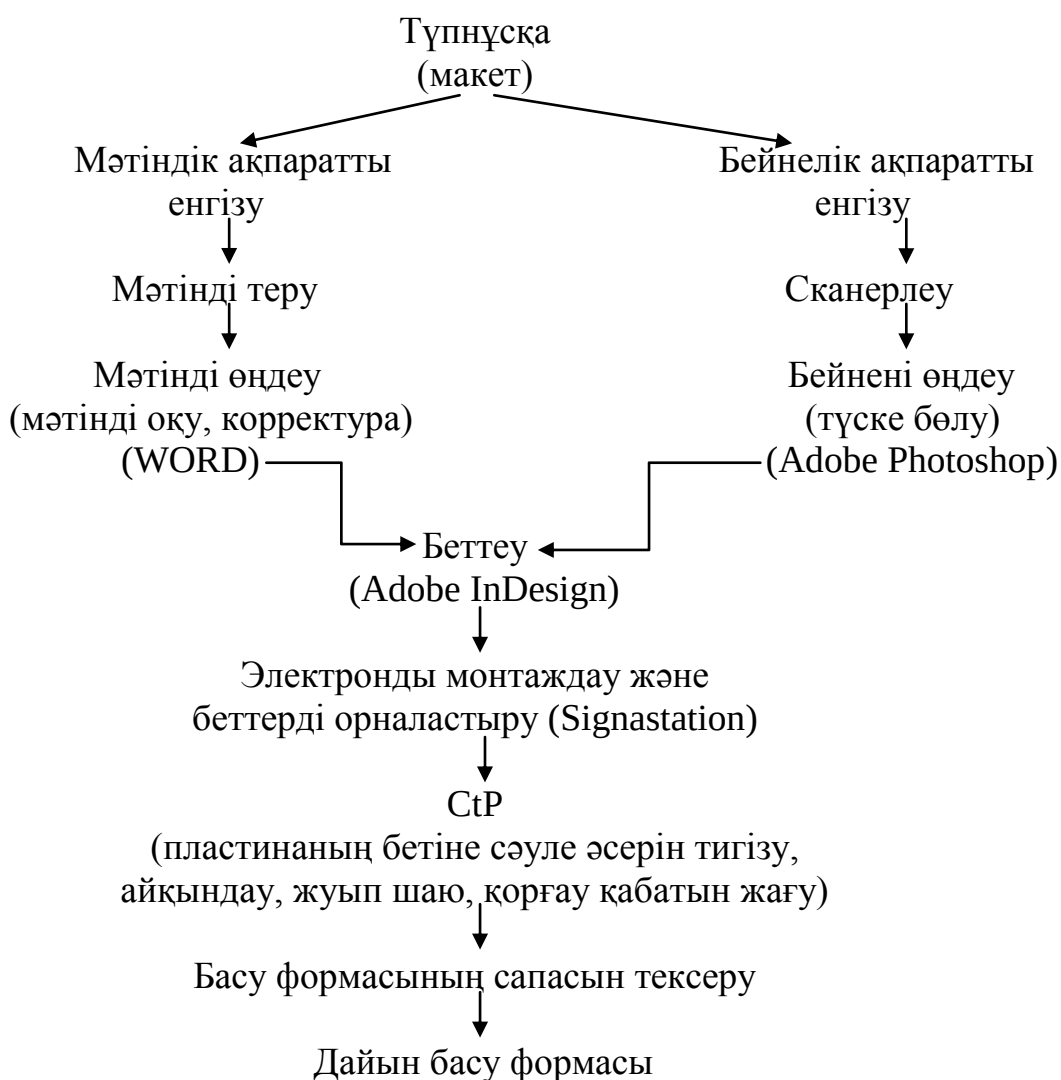
1 Сурет – Кітап өнімдерін даярлаудың басуға дейінгі процесінің технологиялық схемасы
